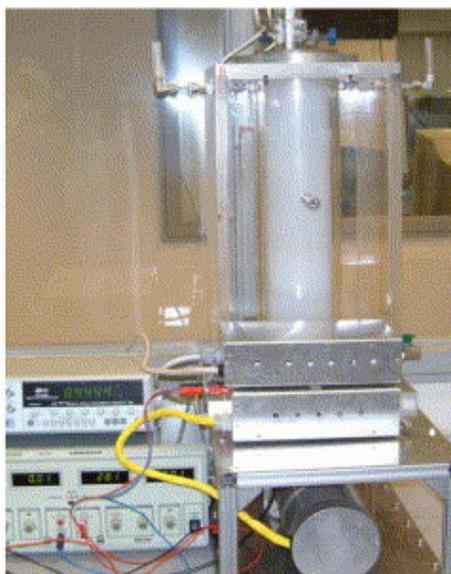
**Figura 3: Reator fotocatalítico Taylor vórtice. Fonte: Dutta; Ray, 2004.**
