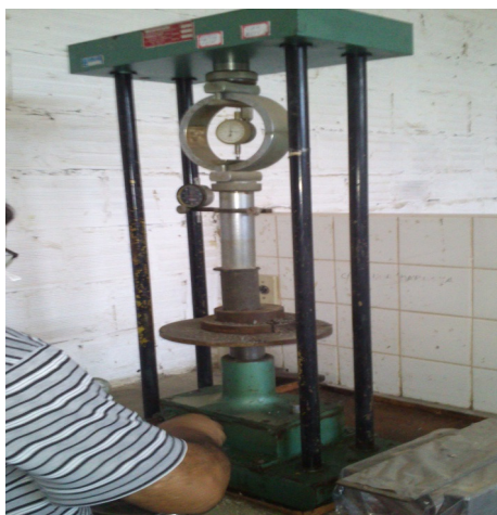
Figura 3: Ensaio de resistência à compressão simples
