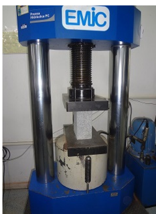
Figura 5: Prensa hidráulica para o ensaio de resistência à compressão. Fonte: Autora do Trabalho, 2014.
