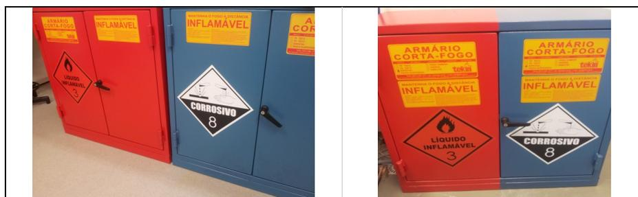
Figura 3: Armários para produtos inflamáveis (vermelho), corrosivos (azul) e conjugados inflamáveis e corrosivos (vermelho e azul).
