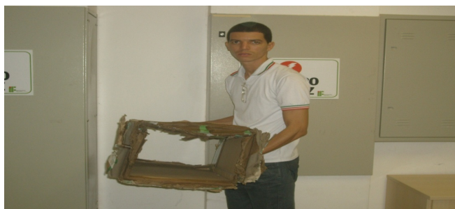
Figura 4 - Danos causados pela umidade ao “coletor”.
