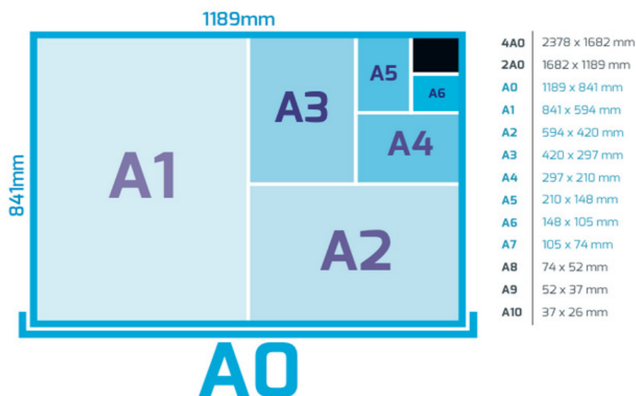
Figura 1: Esquema de proporção dos formatos da série ISO A, juntamente com seus respectivos tamanhos. Fonte: Creative Cópias, 2014.
