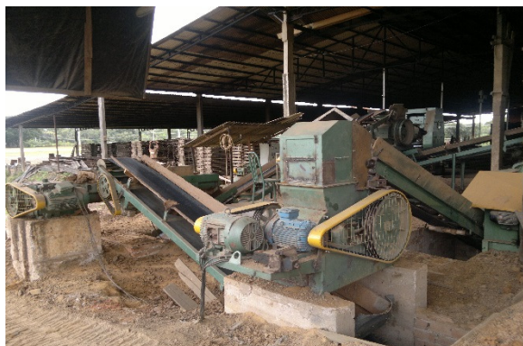
Figura 2 Imagem da máquina utilizada para moagem da argila. FONTE: Nafitalino dos Santos Everton.
