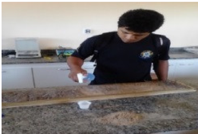
Figura 3 – Monólito sendo impermeabilizado.
