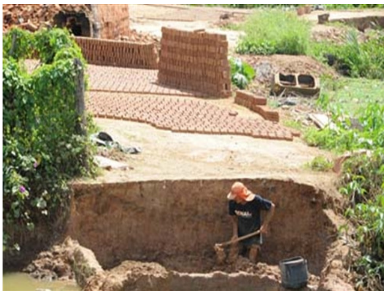
Figura 1 – Escavação manual de argila. Fonte: Wagner Santos.
