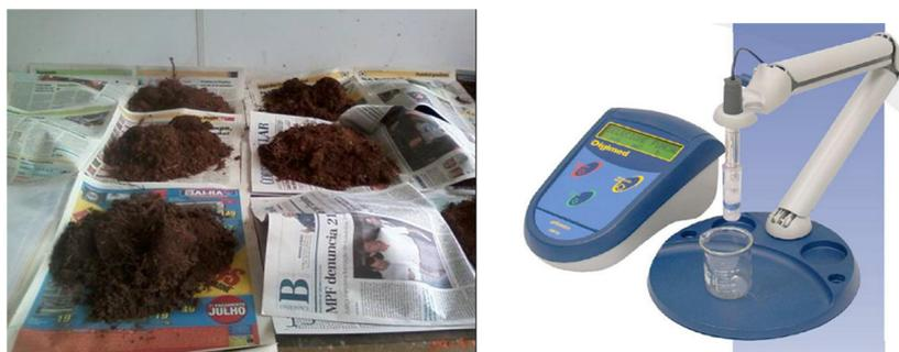
Figura 6: a) Amostras sendo deixadas para secar ao ar. Fonte: Autora b) Imagem ilustrativa do aparelho usado para medir pH. Fonte: [http://www.cial-paulinia.com.br/lista\\_fabricante.asp?f=156&g=2](http://www.cial-paulinia.com.br/lista_fabricante.asp?f=156&g=2).
