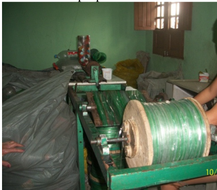
Figura 2 – Maquinário para formação dos fios e armazenamento em bobina.
