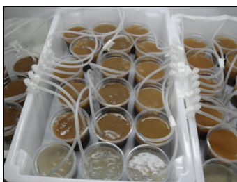
Figura 3: Teste de toxicidade com Branchiura sowerbyi demonstrando as réplicas e o controle realizados para cada ponto amostral.
