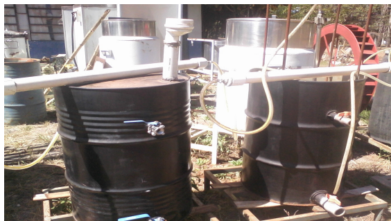
FOTO 1 - Materiais utilizados na construção do biodigestor.
