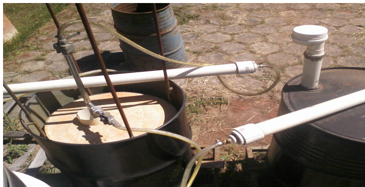
FOTO 2 - No tambor da direita, ocorre o processo de fermentação. No tambor da esquerda, faz-se o armazenamento e distribuição do biogás. Na esquerda, mostra o tambor de 50 lt (reservatório) dentro do tambor de 200 lt.
