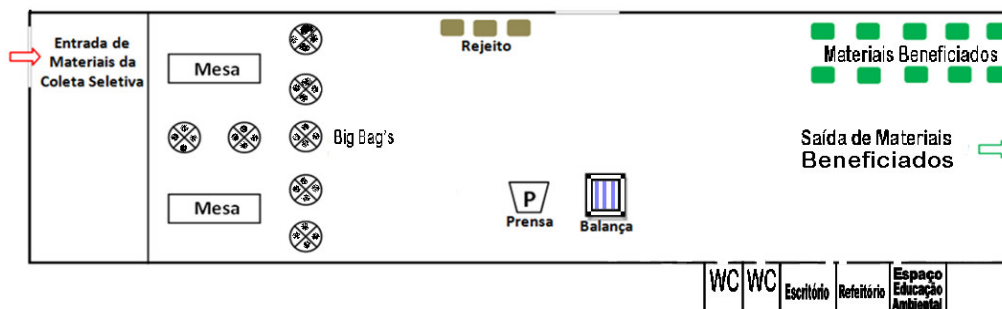
Figura 02: Layout da central de triagem a ser instalada em Itauçu. Adaptação da sugestão de modelo para a mudança de estrutura da central do município de Cidade Ocidental – Goiás. Sugestão realizada no artigo de análise das logísticas dos sistemas de tratamento e disposição final dos resíduos sólidos urbanos deste município (em fase de elaboração) 1 .
