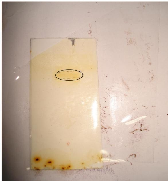
Figura 2 - Placa cromatográfica eluída com solução hexano – acetato 50%
