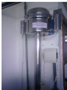
Figura 2: Destilador BIOPAR, modelo BDSL. Fonte: SILVA (2012).
