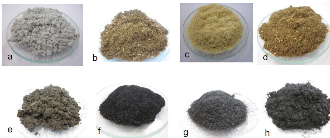
Figura 1: (a) lodo in natura ; (b) grama in natura ; (c) pinus in natura ; (d) pupunha in natura ; (e) lodo carbonizado; (f) grama carbonizada; (g) pinus carbonizado; (h) pupunha carbonizada
