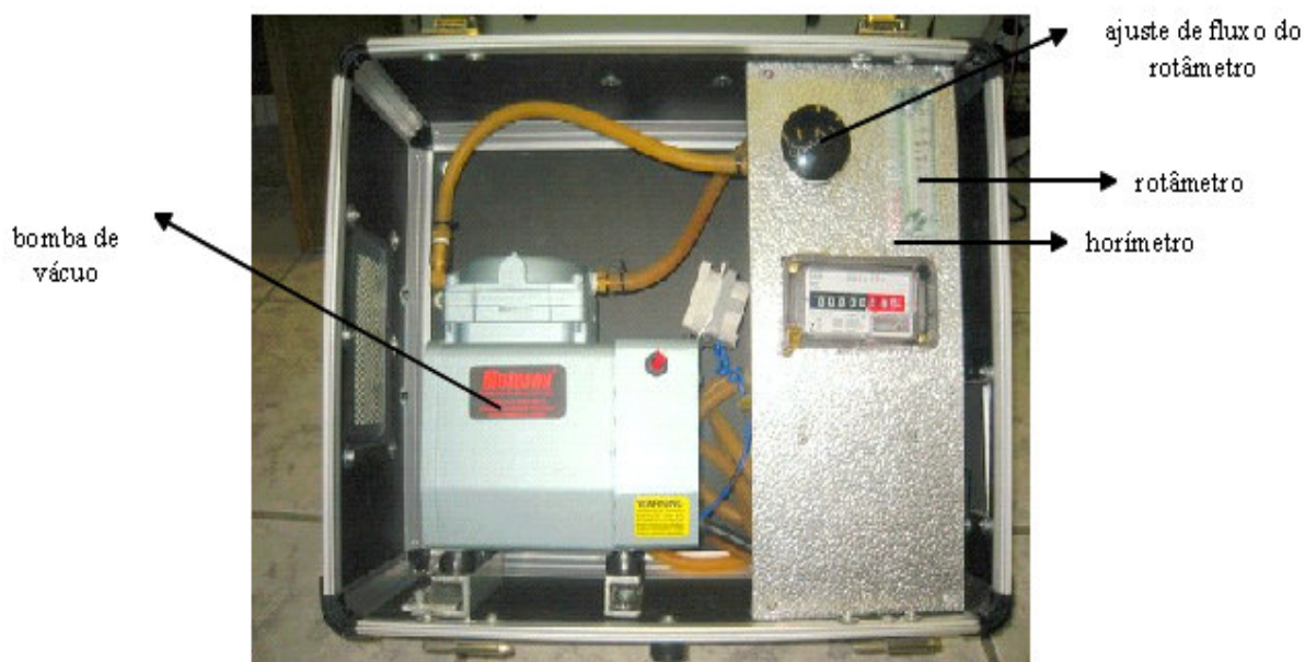
Figura 3: Arranjo Esquemático do Coletor de Material Particulado (LPAE et al., 2009)
