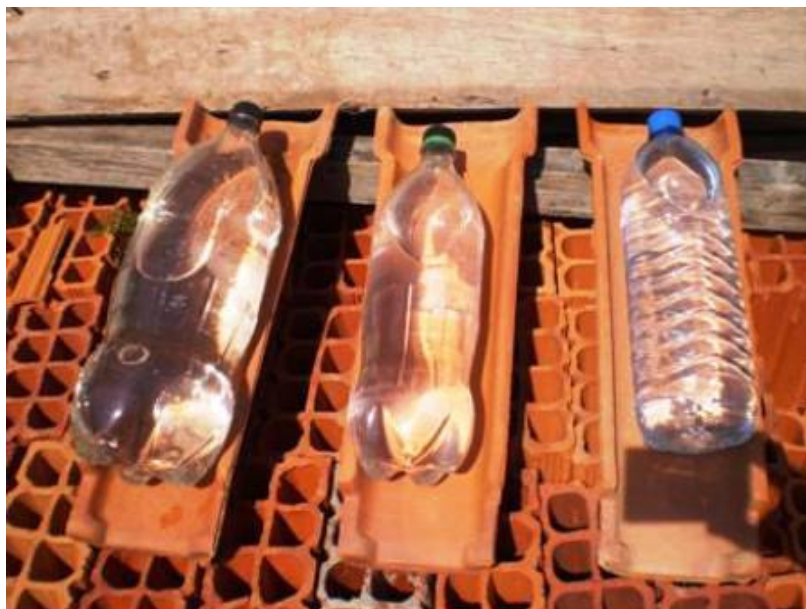
Figura 2 - Garrafas PET, com água, em processo de desinfecção.
