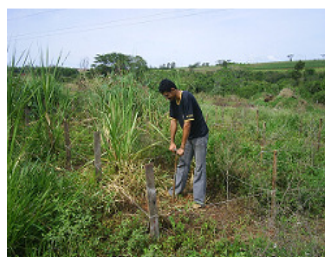
FIGURA 3: Utilização do Trado para extração das amostras de solo
