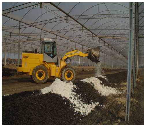
Figura 2: Aplicação do composto de carbonato e sulfato de cálcio na aleira para fabricação do fertilizante
